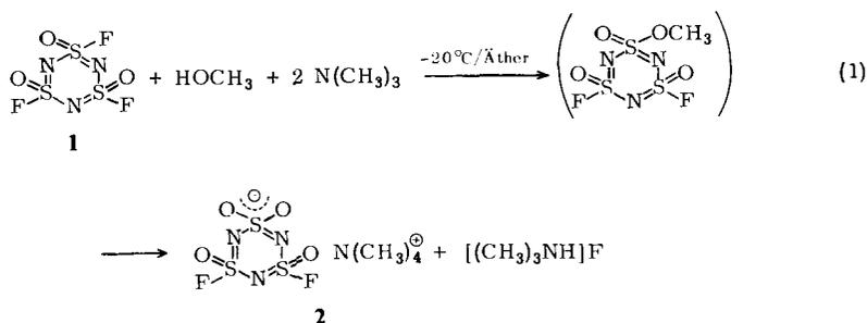
Reines **2** erhält man als Rückstand, wenn das Aminhydrofluorid bei 100°C i. Vak. aus dem Reaktionsgemisch heraussublimiert wird. Formel **2** gibt die elektronischen Verhältnisse in diesem cyclischen Anion nur unvollständig wieder, es gibt experimentelle Befunde, die auf eine Verteilung der negativen Ladung über das Ringsystem hinweisen<sup>6)</sup>. Das Anion ist auch direkt durch Hydrolyse von **1** in Gegenwart von Tetraphenylphosphoniumchlorid darstellbar [Gl. (2)].
